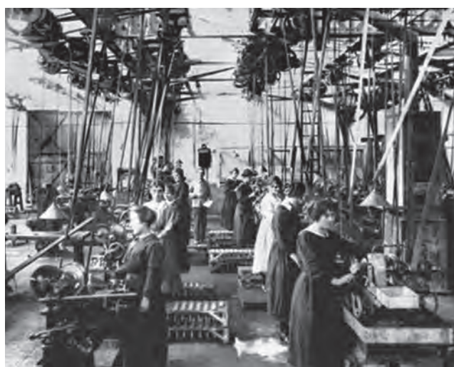
Tours et meules d'ébarbage. Fabrication d'éléments pour obus de 75 mm de type Shrapnel. Usines des Automobiles et Cycles Peugeot, Audincourt (Doubs), 1917. FDPMMH
